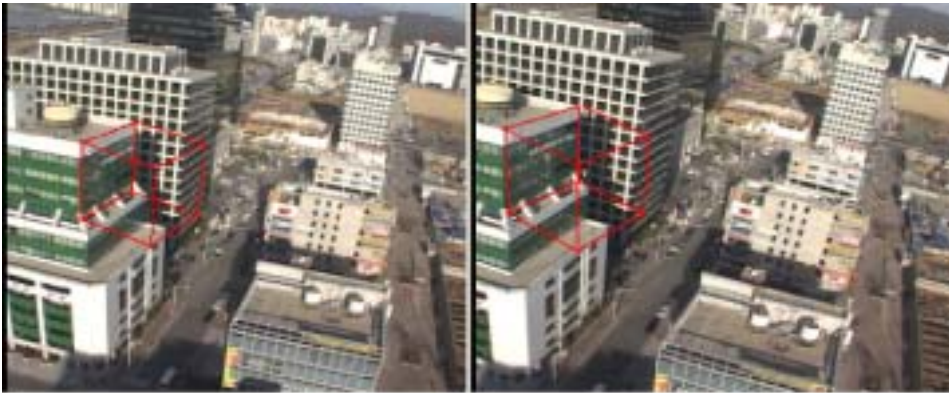
〈그림 9〉 카메라 좌표계와 그래픽 좌표계를 연결하기 위한 작업. 카메라 좌표계 속에 그래픽 좌표계의 위치와 방향을 설정해야 하는데, 이미지를 이용한 방법을 사용한다.
